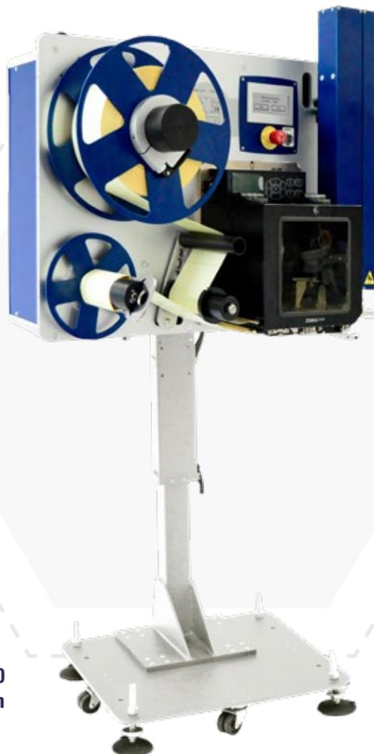
**Touch screen da 3,8" per la configurazione dei parametri di sistema**
