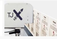
Термоструйные принтера компании United Barcode Systems, разработаны для маркировки и штрихкодирования первичной (единичной) упаковки.
